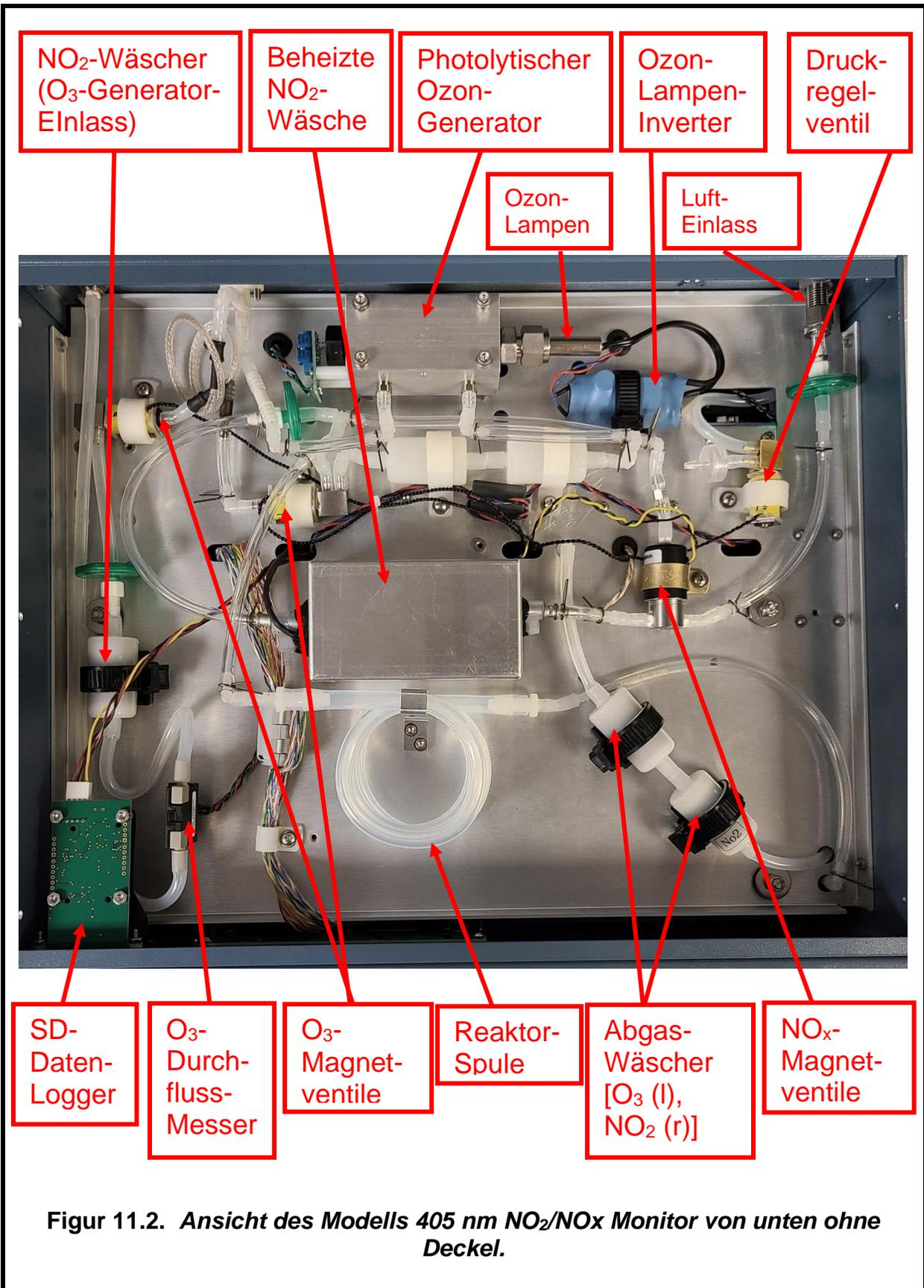
**Figur 11.2. Ansicht des Modells 405 nm NO<sub>2</sub>/NO<sub>x</sub> Monitor von unten ohne Deckel.**
