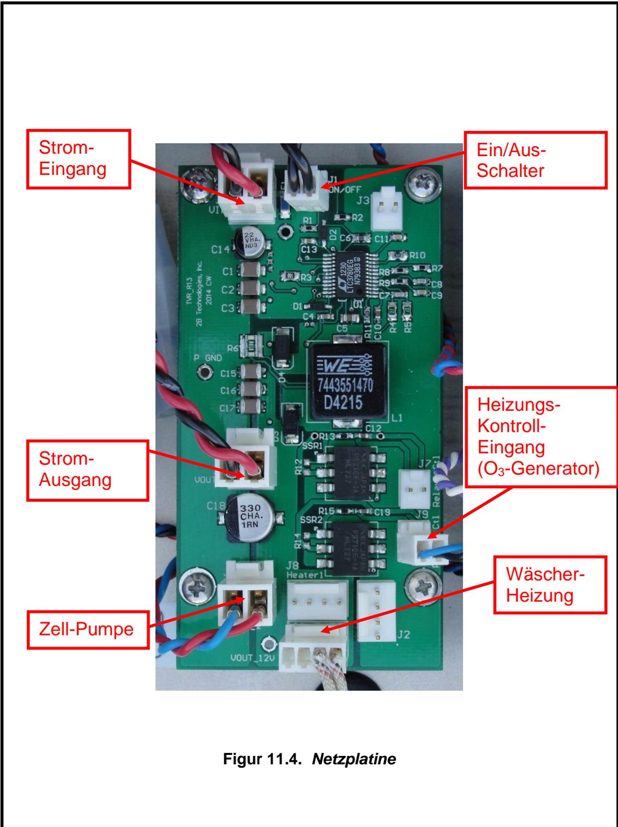
**Figur 11.4. Netzplatine**
