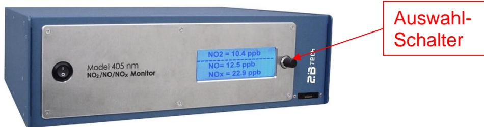
Um das Menü zu erreichen, drücken Sie den Schalter (für bis zu mehrere Sekunden), bis das Display **Menu** anzeigt. Dann den Schalter loslassen. Das Display wird nun anzeigen:
