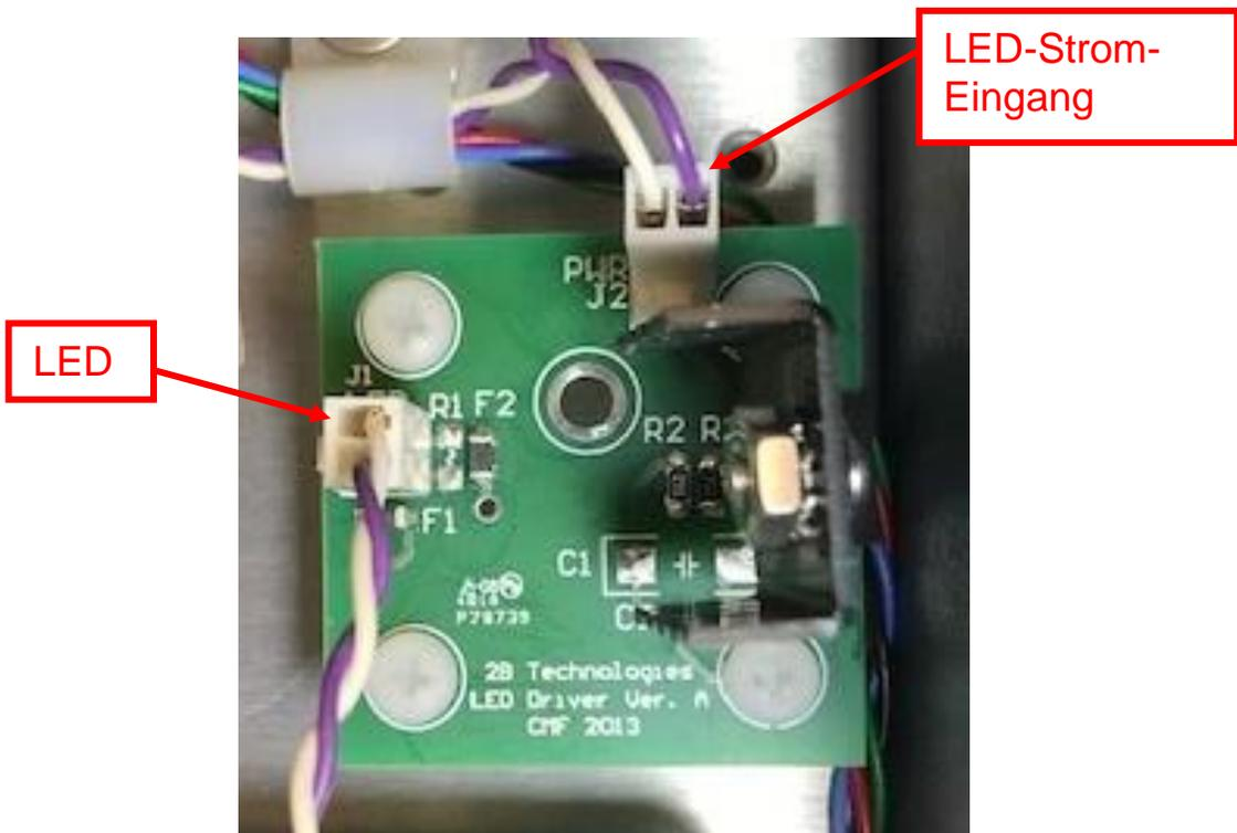
Figur 11.5. LED-Netzplatine
