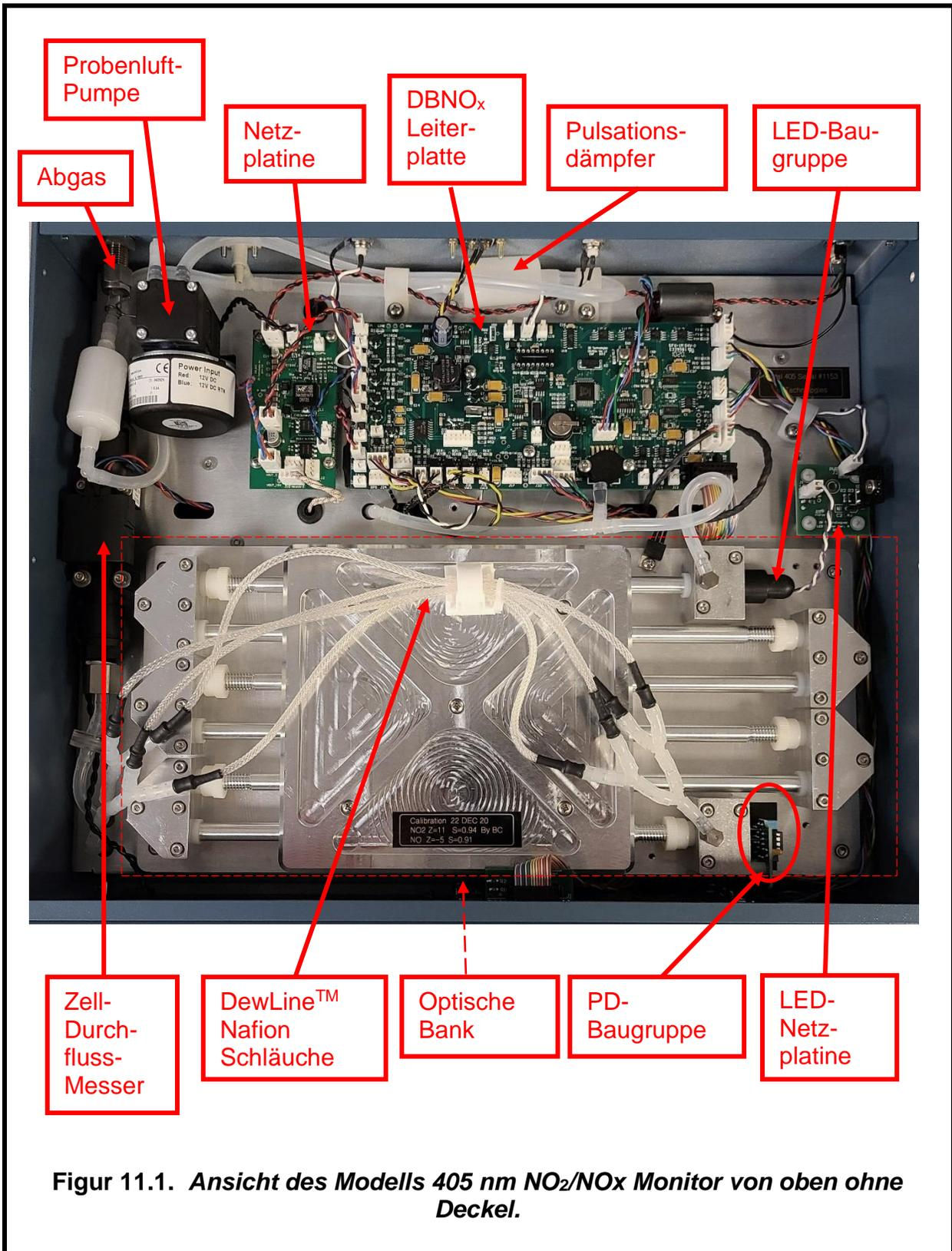
Figur 11.1. Ansicht des Modells 405 nm NO<sub>2</sub>/NO<sub>x</sub> Monitor von oben ohne Deckel.
