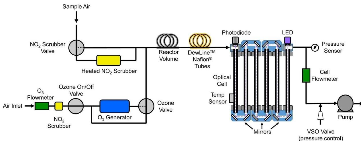
**Figur 1.1. Schematisches Diagramm des Modell 405 nm NO<sub>2</sub>/NO/NO<sub>x</sub> Monitors.**
